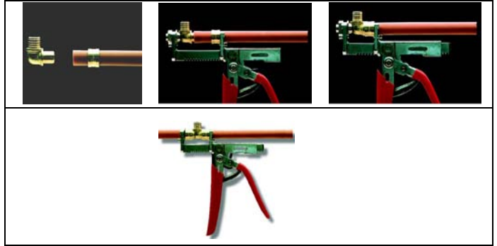
Figure 5 : réalisation des assemblages
